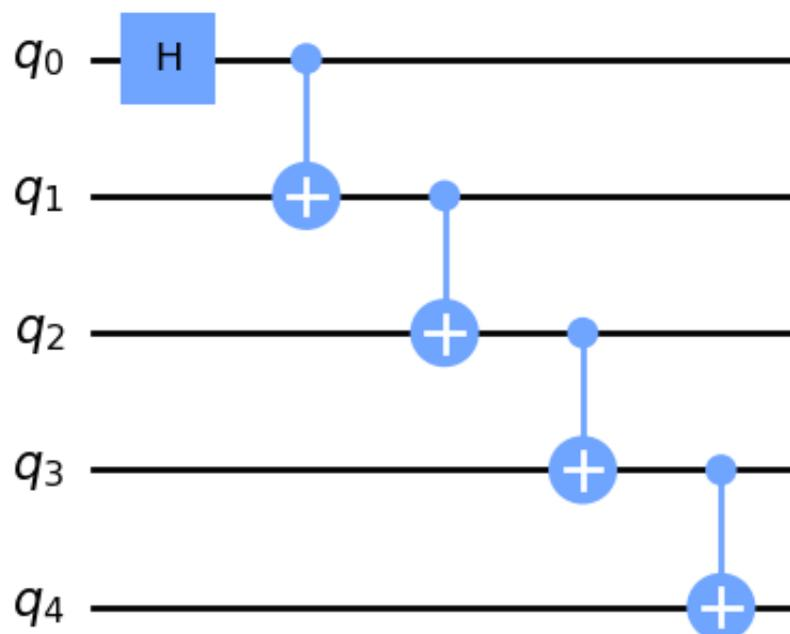
量子ビット数を変えてGHZ回路を作成し、実行時間を計測すると、シミュレータと実機で異なる傾向が観察できるはずです。
