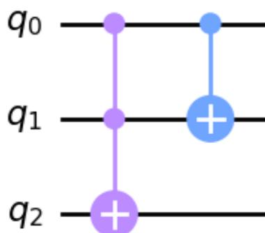
1つめのゲートはToffoliゲート (CCNOTゲート) で、2つのコントロールビット (図では黒丸) がどちらも $|1\rangle$ の時、ターゲットビット (図では+) を反転させます。2つめのゲートはCNOTゲートで、コントロールビットが $|1\rangle$ の時、ターゲットビットを反転させます。さまざまな入力に対して、加算と繰り上がりが出力されることを確認してみてください。
